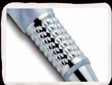
Finitura godron con profilo a piramide tronca eseguita con utensili in diamanti naturali, lucidata e brillantata. / A godron finish, cut-off pyramid profile realized by natural diamond tools, polished and buffed.
